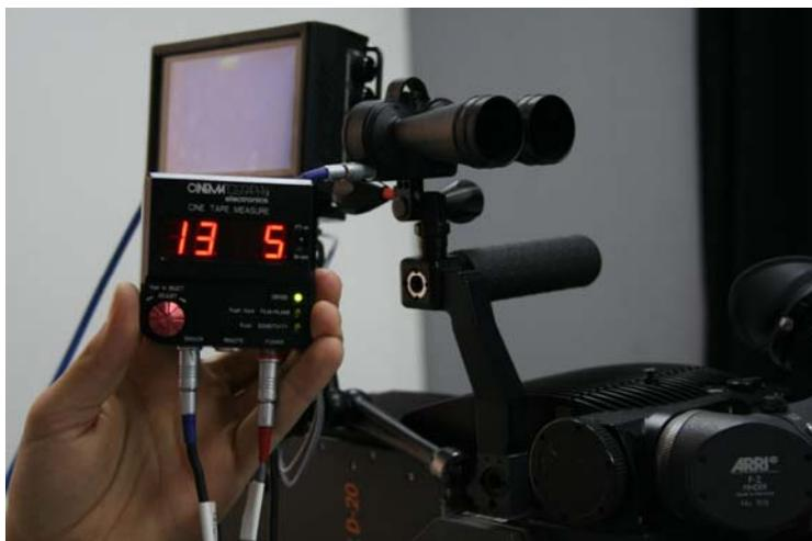
2/ Les deux "gros" réglages du CT sont: **sa sensibilité**, paramétrable de 0 à 100%, et qui permet de demander à l'appareil de ne réagir qu'aux objets les plus mouvants en faisant abstraction des objets parasites immobiles (exemple: un acteur qui est le seul à bouger au milieu d'un décor "encombré" et dont certains éléments pourraient "accrocher" le signal ultrason du CT).
