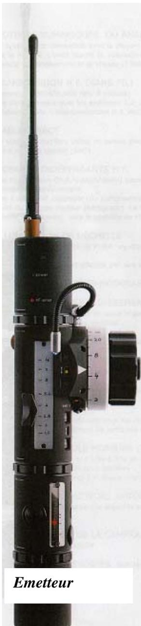
Pour simplifier, **l'émetteur envoie ses données à un récepteur qui lui contrôle les moteurs pouvant modifier la mise au point, le diaphragme, le zoom et le déclenchement de la caméra.** L'émetteur peut être séparé du récepteur jusqu'à une longueur de 600 m (2000 pieds) en extérieur et 8 m (300 pieds) en intérieur.
